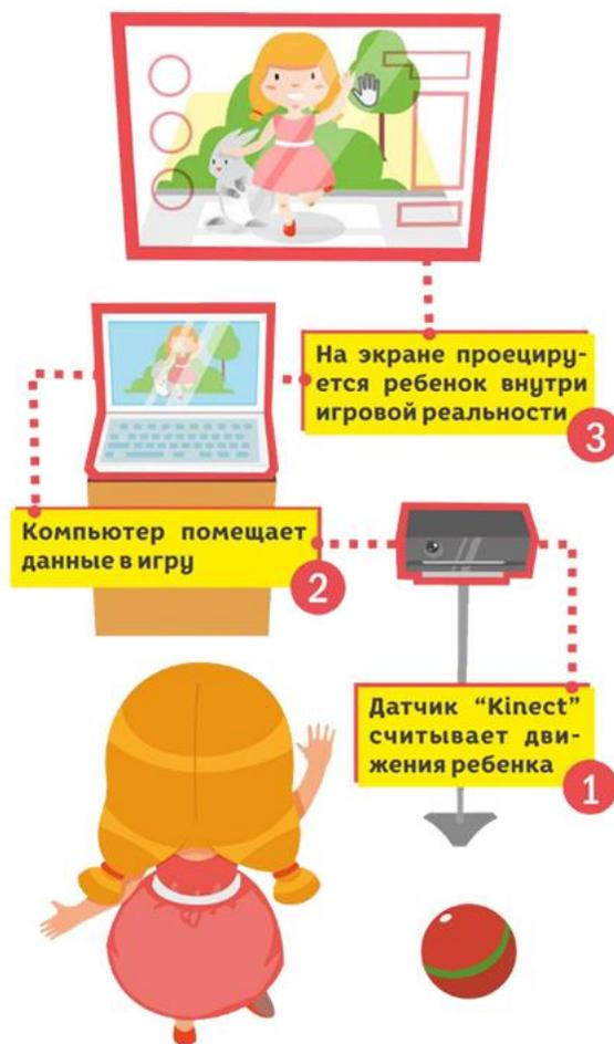
Для работы с комплексом потребуются телевизор или проектор, а также ноутбук, к которому подключается датчик Kinect, входящий в комплект. Датчик очень компактный, поэтому его можно переносить и использовать в любом помещении.
